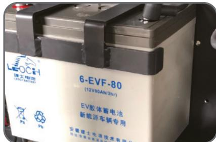
Deux batteries 12V (24V) en AGM sans entretien avec capacité de 85Ah.
