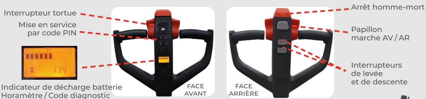
Une capacité de charge jusqu'à 1200kg avec une aptitude de surmonter des rampes d'un angle de 5/10% (Avec charge/Sans charge) ce qui facilite la manœuvrabilité du gerbeur dans les quais de chargement et le déplacement dans les entrepôts dans différentes conditions
